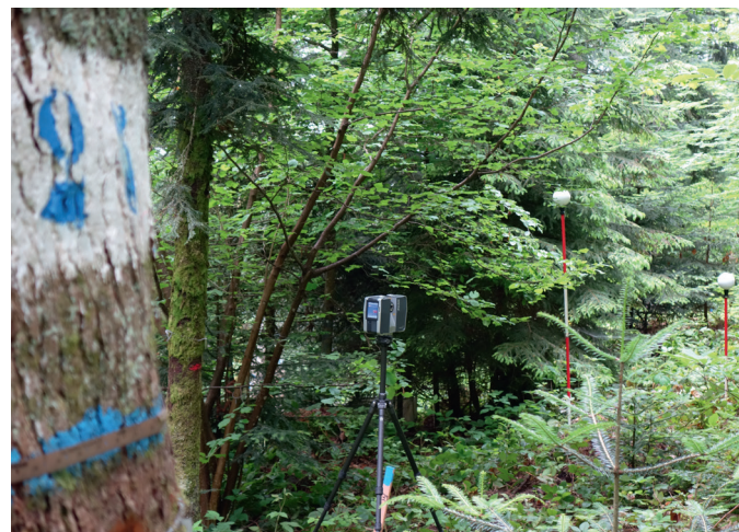
Innovation : test du laser terrestre sur placette RENECOFOR
