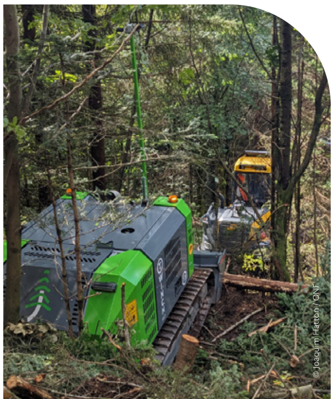
Treuil T-Winch positionné en soutien de l'abatteuse, sur une piste transversale à l'aplomb du cloisonnement
