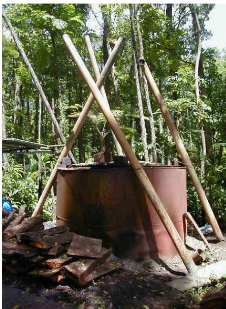
Figure 31 : Four à charbon traditionnel (ONF, 2010)
