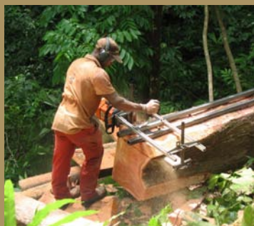
Exploitation dite «à l'alaskane», où les planches sont débitées sur le lieu d'abattage (ONF, 2015)
