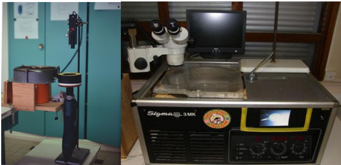
Figure 1. A gauche le premier prototype de CAVITRON issu des laboratoires de l'INRA de Clermont-Ferrand. A droite, le premier CAVITRON "sécurisé" développé à partir d'une centrifugeuse à l'INRA de Bordeaux.
