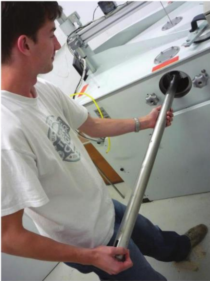
Figure 3. Le dernier-né des Cavitrans, dessiné pour mesurer des espèces à vaisseaux très longs: le CAVI1000.
