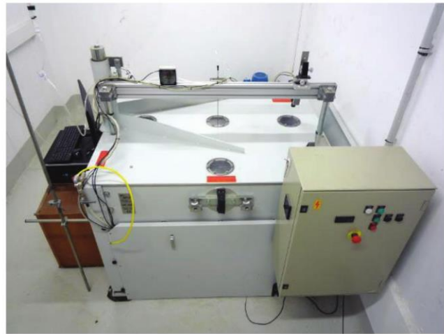
Figure 3. Le dernier-né des Cavitrans, dessiné pour mesurer des espèces à vaisseaux très longs: le CAVI1000.
